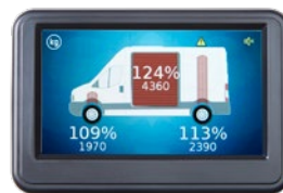
Avviso di sovraccarico totale
